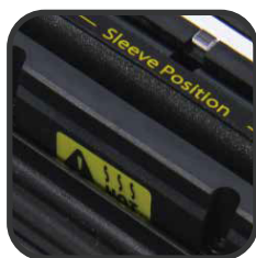
Empalme rápido de 9 segundos, calentamiento en 20 segundos
