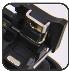
Accesorio de calentamiento SOC desmontable
