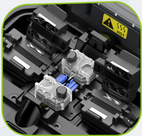
Electrodos de 5000 empalmes de vida útil
